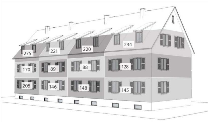
Abbildung 7.7 Jahresheizwärmebedarf des Bestandes in kWh/m²a
